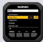
À partir du DF115B, cette fonctionnalité ajuste automatiquement l'angle de trim en fonction du régime moteur. Elle règle automatiquement le meilleur angle de trim et permet d'atteindre les différentes vitesses tout en contrôlant la consommation de carburant.
